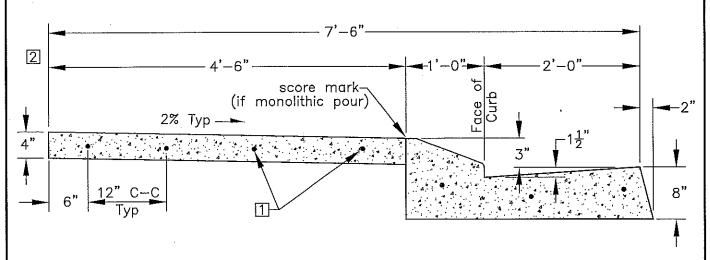
ROLL CURB, GUTTER AND SIDEWALK
